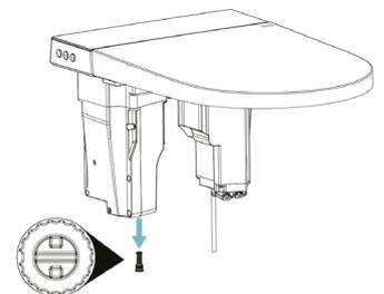
**TIPP:** Das regelmäßige Entleeren des Tankes entfernt abgesunkene Schwebeteilchen, die zu Druckverlust und Beschädigungen an Ihrem Dushlet führen können. Dieser Schritt entfällt, wenn der Kalkschutzfilter regelmäßig gewechselt wird.
