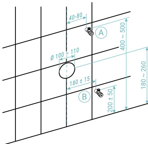
Maße für den Wandabfluss sowie die empfohlene Position des Eckventils (Wasserleitung) als Alternative A oder Alternative B
