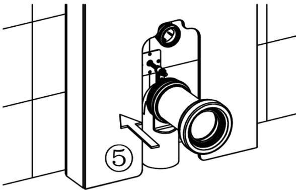
Setzen Sie das Abflussrohr auf den Ablaufrohrstutzen (5).
