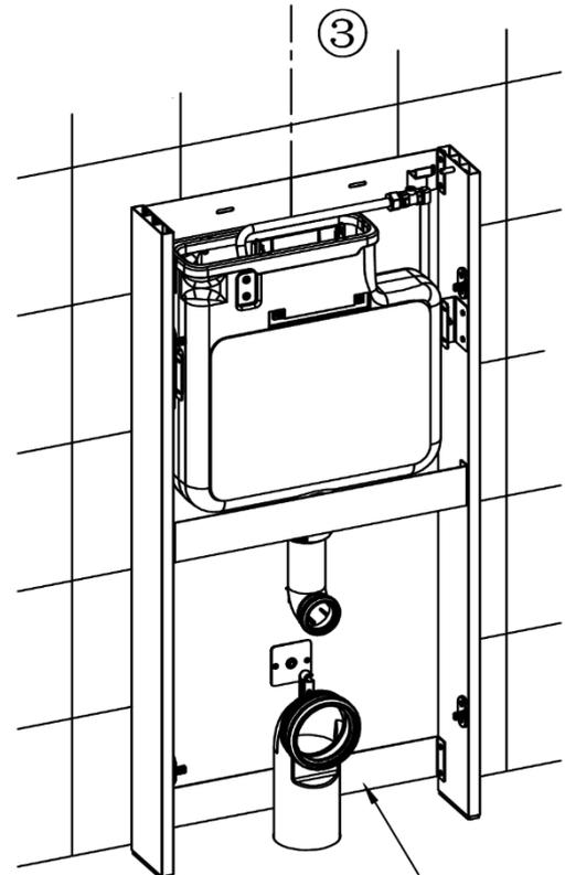
Stellen Sie die Spülwand gegen die Wand und positionieren Sie sie so, dass die Mittellinie an der Wand und die Mittellinie der Spülwand übereinstimmen (3).
