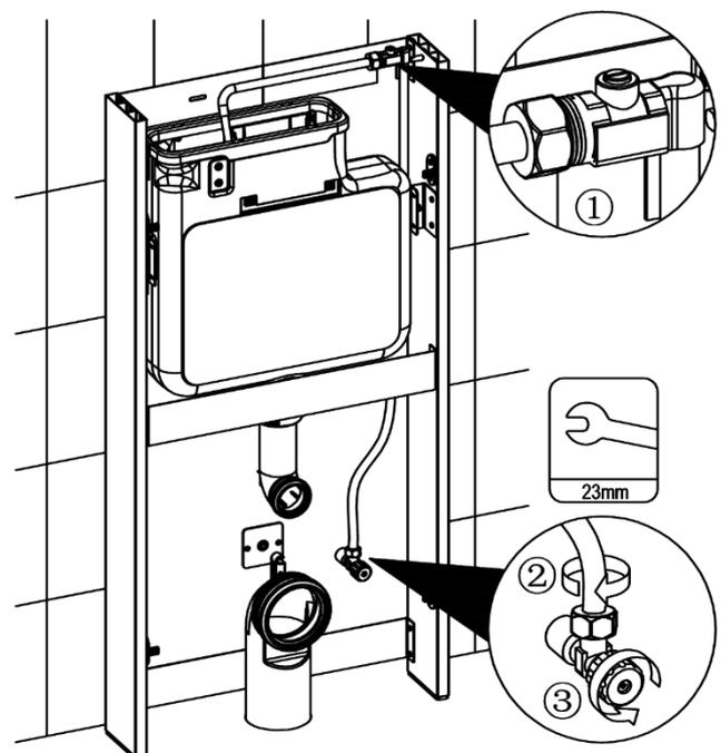
Legen Sie das Absperrventil wieder in die Halterung (1). Verschrauben Sie den Druckschlauch mit dem Eckventil und öffnen Sie dieses (2+3).
