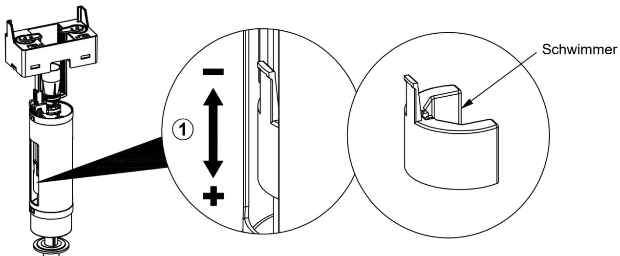
Um die Wassermenge zu erhöhen, bewegen Sie den weißen Schwimmer mit der Nase nach oben. Bewegen Sie den Schwimmer nach unten, um die Wassermenge zu verringern.
