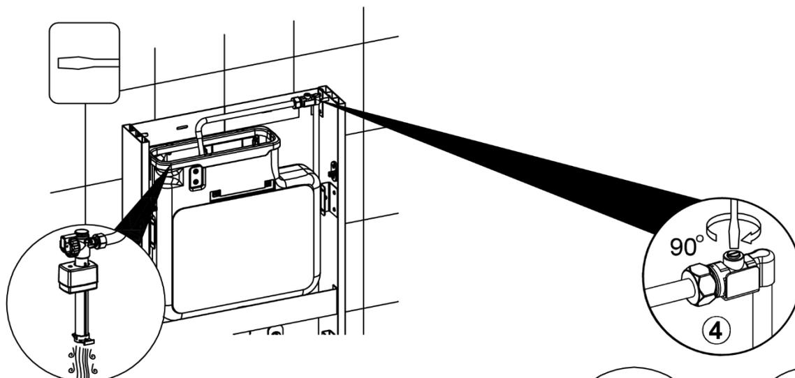
Öffnen Sie das Absperrventil (4) am Schlauch, damit das Wasser den Spülkasten befüllen kann. Überprüfen Sie anschließend alle wasserführenden Teile auf Dichtigkeit.
