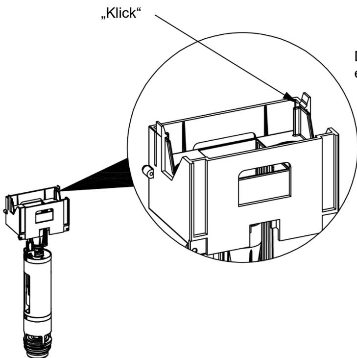
Drücken Sie das Auslaufventil hinunter, bis es in der korrekten Position einrastet.
