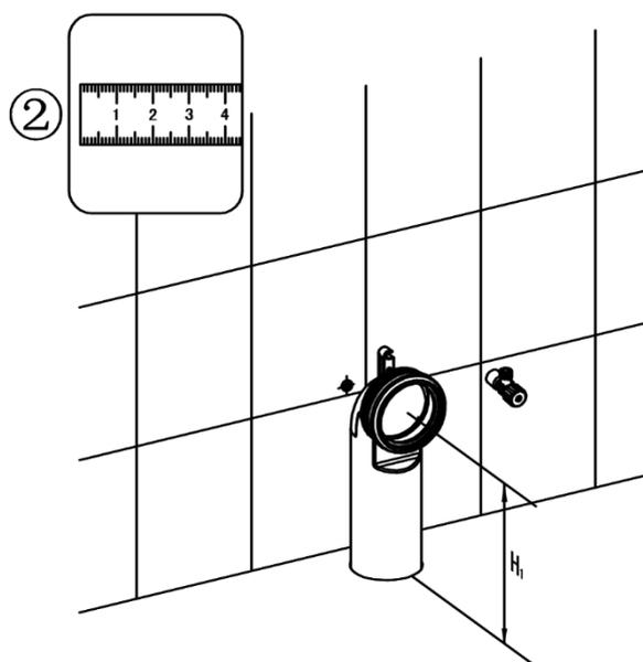
Messen Sie nun die Mitte des Abflussrohres, ausgehend vom Boden (siehe Bild).
