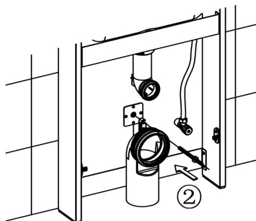
Befestigen Sie das Abflussrohr. Nutzen Sie hierfür die Platte aus dem Fixierungsset (2).
