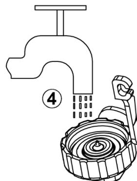
Um den Wasserstop zu reinigen, schrauben Sie die Überwurfmutter ab.
