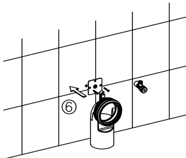
Befestigen Sie die kleine Halterungsplatte (Fixierungsset) an der Wand. Nutzen Sie hierzu die kleinen Schrauben (6).
