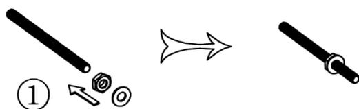
Drehen Sie die Muttern auf die Bolzen, so dass sie sich ca. in der Mitte befinden (1).
