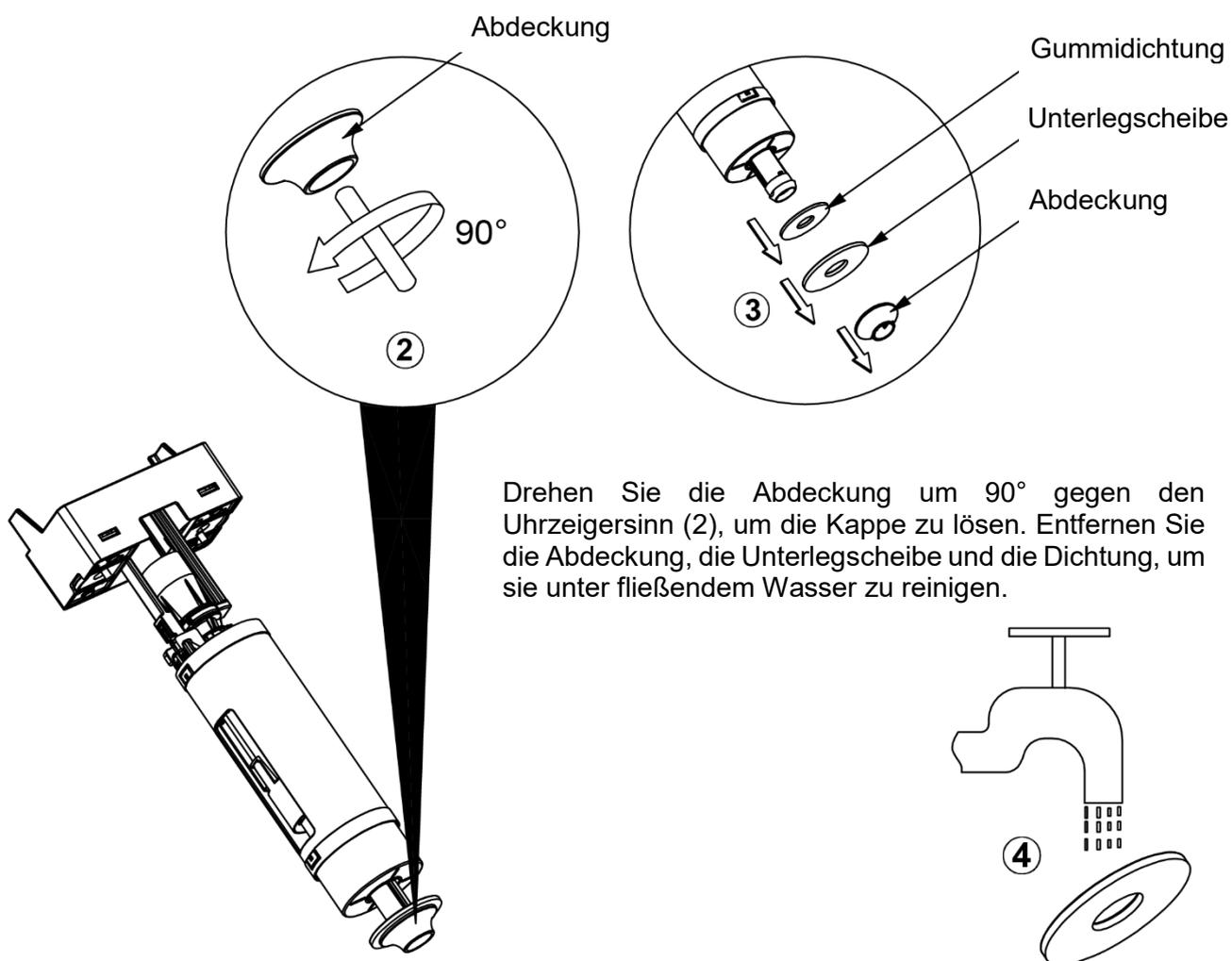
Drehen Sie die Abdeckung um 90° gegen den Uhrzeigersinn (2), um die Kappe zu lösen. Entfernen Sie die Abdeckung, die Unterlegscheibe und die Dichtung, um sie unter fließendem Wasser zu reinigen.
