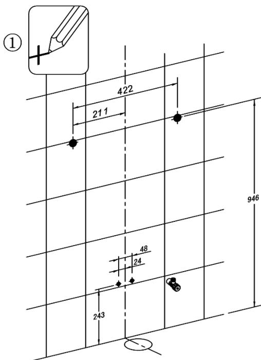
Setzen Sie eine Markierungslinie ausgehend von der Mitte des Abflussrohres an der Wand, wie im Bild angegeben. Nun Setzen Sie die vier Bohrmarkierungen links und rechts von der Mittellinie, wie im Bild (1) gezeigt.
