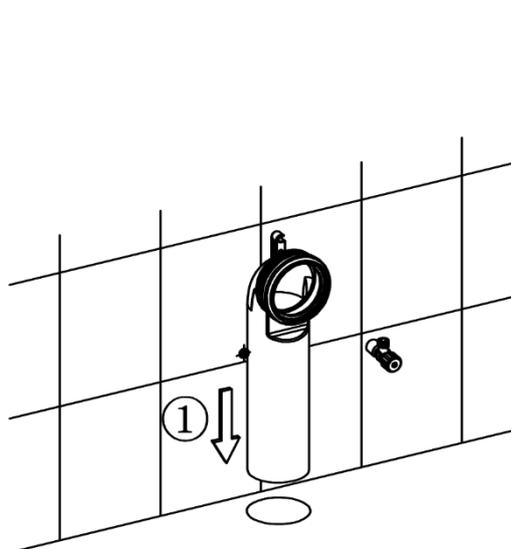
Schieben Sie das Abflussrohr in das Bodenloch. Achten Sie dabei darauf, dass das Rohr vollständig eingeschoben wurde (1).
