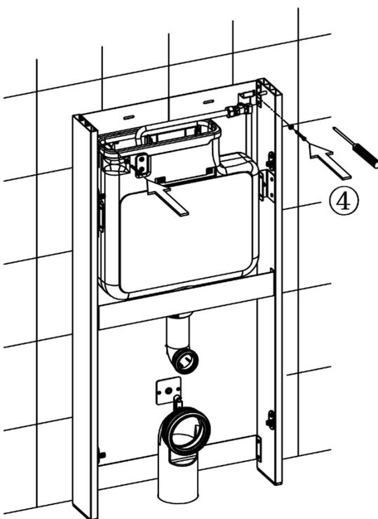
Drehen Sie die passenden Schrauben in die dafür vorgesehenen Kunststoffdübel fest in die Wand (4).
