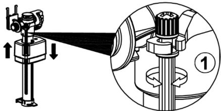
Um die Wassermenge zu erhöhen, bewegen Sie den Schwimmer nach oben. Bewegen Sie den Schwimmer nach unten, um die Wassermenge zu verringern.
