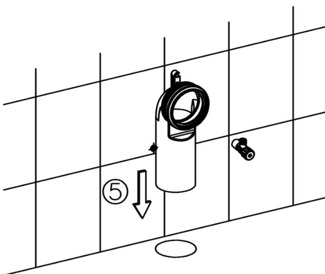
Schieben Sie das Abflussrohr nun wieder in das Bodenloch. Achten Sie auch hier wieder darauf, dass es vollständig eingeschoben ist (5).
