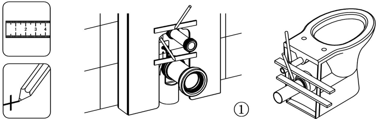
Stecken Sie die Anschlussstutzen Zu- und Ablaufrohr in die jeweilige Position in der Wand und markieren Sie diese bündig zur Wand. Setzen Sie nun die Anschlussstutzen in die Keramik und markieren diese auch hier bündig zur Keramik (1).
