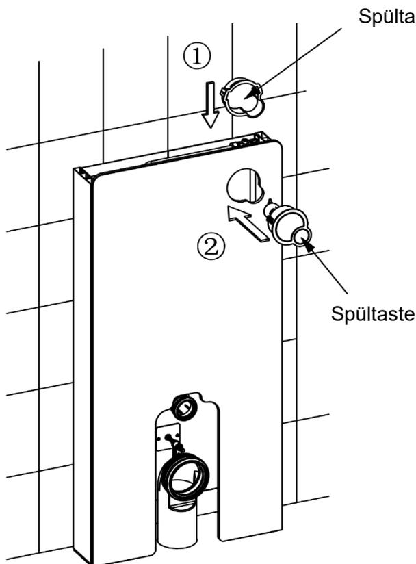
Lösen Sie den Kunststoffrahmen von der Spültaste und führen Sie diesen von oben in die Spülwand ein (1).
