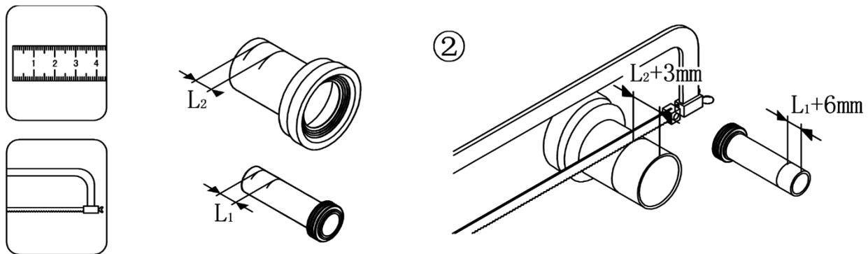
Beachten Sie, dass Sie bei der Markierung L1 6mm hinzurechnen. Bei der Markierung zu L2 rechnen Sie bitte 3mm hinzu.
