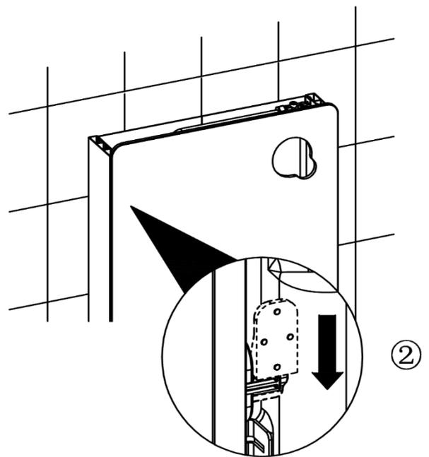
Befestigen Sie die Glasfront auf dem Aluminiumrahmen der Spülwand, indem Sie diese leicht nach unten schieben, sodass sie in der Halterung des Rahmens einrastet (2).
