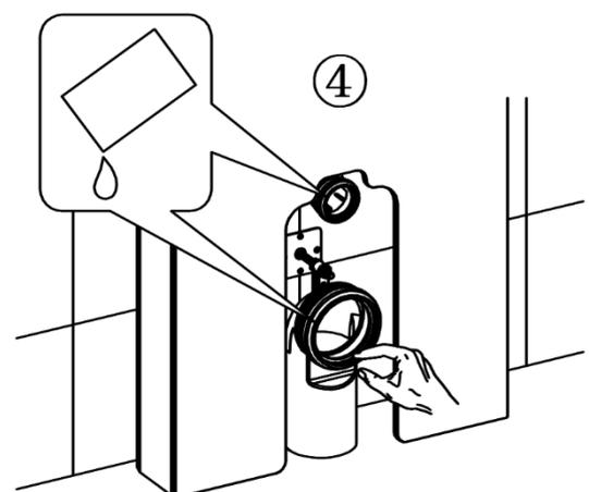
Benetzen Sie die Rohre mit Silikonöl (4).
