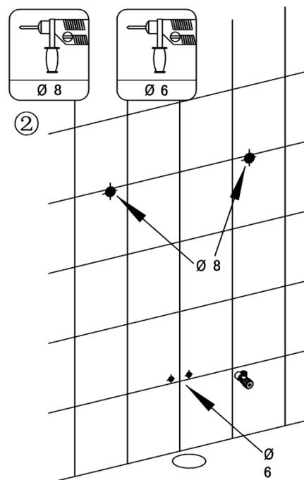
Bohren Sie nun die Löcher an den markierten Stellen in Wand und Boden. Setzen Sie danach die passenden Dübel (2).
