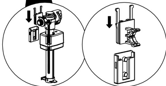
Setzen Sie das Füllventil wieder ein (1), verbinden den Schlauch (2) und drehen das Absperrventil wieder auf (3).
