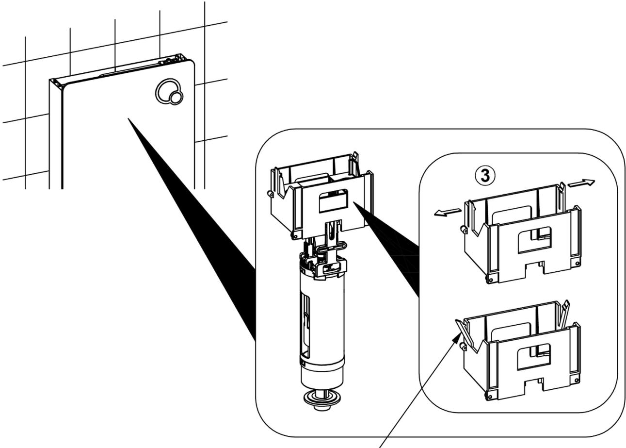
Öffnen Sie die Verschlüsse der Aufhängevorrichtung (3) und ziehen Sie das Auslaufventil nach oben heraus (4).
