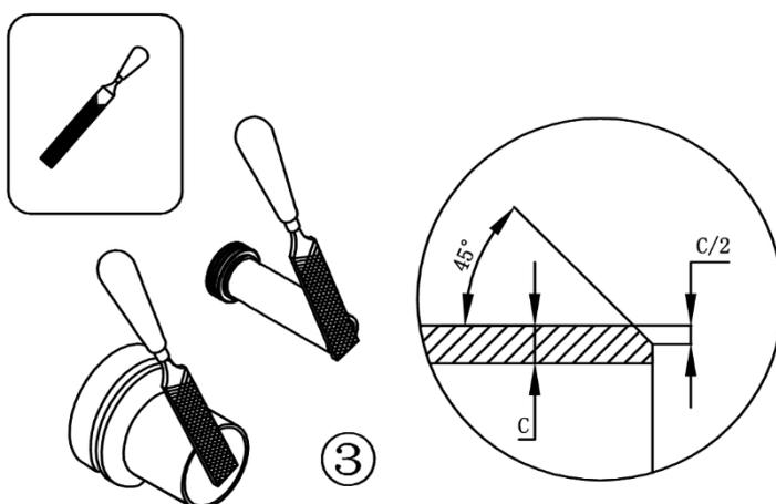
Feilen Sie den abgesägten Rand beider Rohre in einen 45° Winkel (3).
