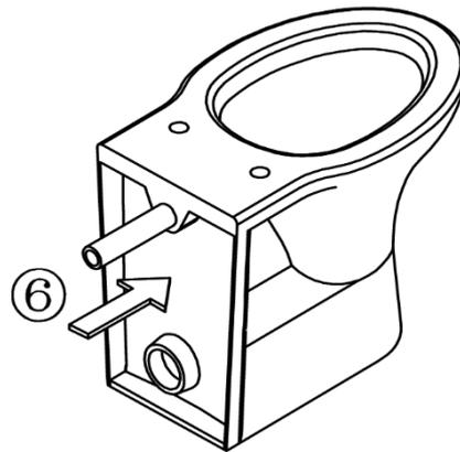
Setzen Sie das Spülrohr in die Keramik (6).
